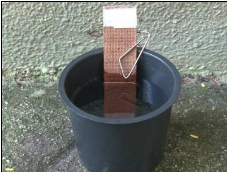
Figura 8: Imagem de uma ovitrapa feita de vaso de plantas, utilizando um laminado de madeira para oviposição
