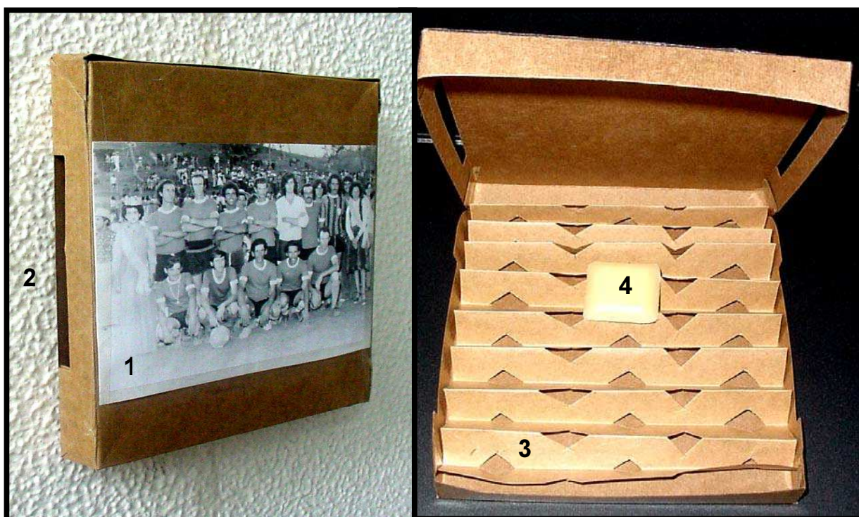
Figura 17. Biosensor utilizado nos trabalhos de campo em Piracema (MG) e Arneiroz (CE). À esquerda, parte externa apresentando fotografia à escolha do morador (1) e detalhe da abertura lateral (2). À direita, parte interna contendo sanfona de papel com orifícios (3) e dispositivo de liberação lenta e contínua dos odores (4).
